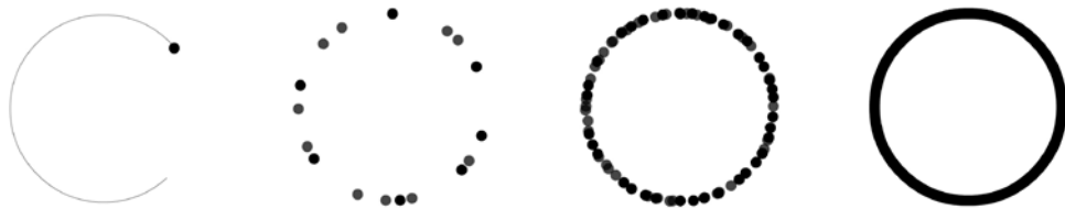
Rys. 2. W pewnym wąskim zakresie prędkości możemy obserwować ruch poruszającego się punktu. Zwiększenie szybkości ruchu powoduje jednoczesną ekspozycję punktu w wielu różnych pozycjach. W końcu, przy odpowiedniej prędkości, poruszający się punkt utworzy pozornie trwałe obiekty
